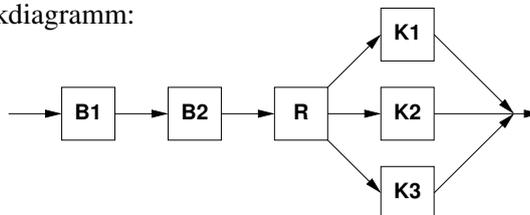
Strukturformel:  $S = B_1 \wedge B_2 \wedge R \wedge (K_1 \vee K_2 \vee K_3)$
